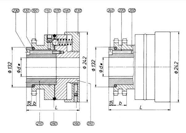
M<sub>+</sub> min. = 49 Nm  $M_{t}$  max. = 1280Nm
